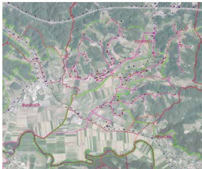
Z rožnato barvo je označen razvod optičnega omrežja v okviru projekta OPIC TEL.
